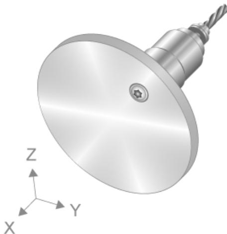
Abb. 115: Exzentrerscheiben-Kinematik mit Drehung um X
