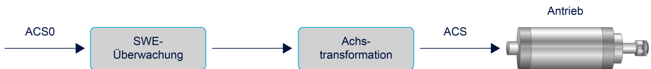
Abb. 54: Eingang Rückwärtstransformation mit SWE-Überwachung
