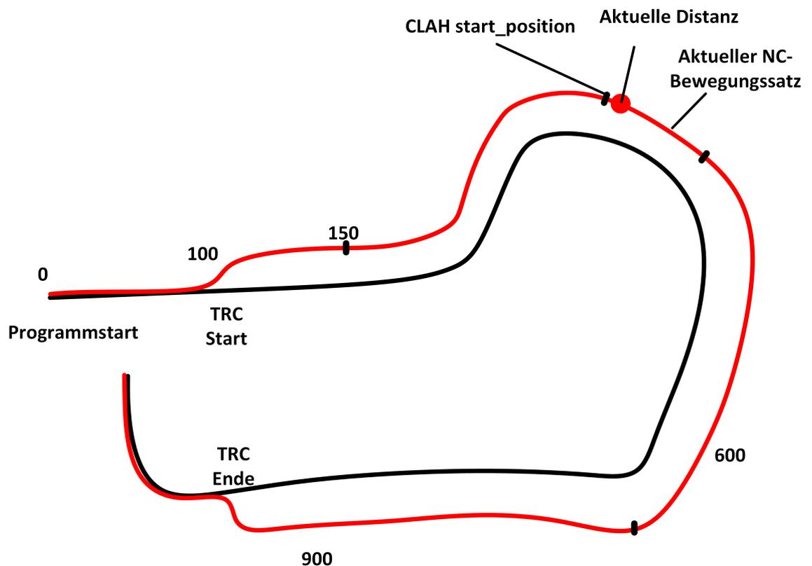
Abb. 5: Schematische Darstellung - Distanz und  $CLAH_{start\_position}$
