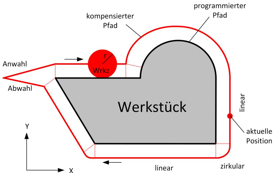
**Abb. 1: Beispiel einer programmierten Kontur mit Werkzeugradiuskorrektur**
