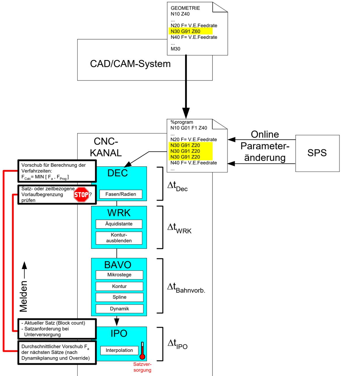
Abb. 2: Daten zur Bestimmung des Decodervorlaufs
