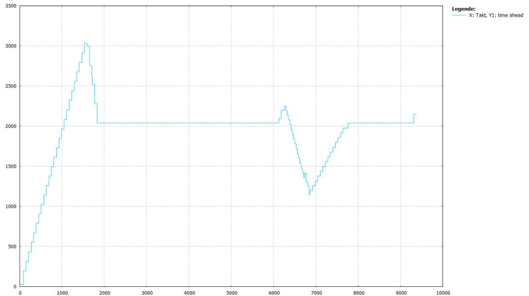
**Abb. 12: Vorlaufbegrenzung mit Berücksichtigung der Durchschnittsgeschwindigkeit (Default bzw. P-CHAN-00428 = 1, Satzlängen 40mm und aktive Vorschublimits)**
