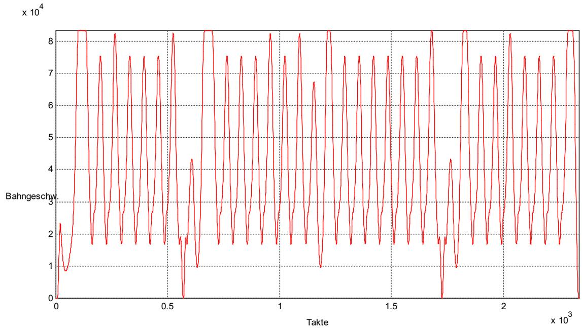
**Abb. 10: Vorlaufzeit: 0.1 Sekunden, Satzversorgung pulsiert stark, Bahngeschwindigkeit schwankt**
