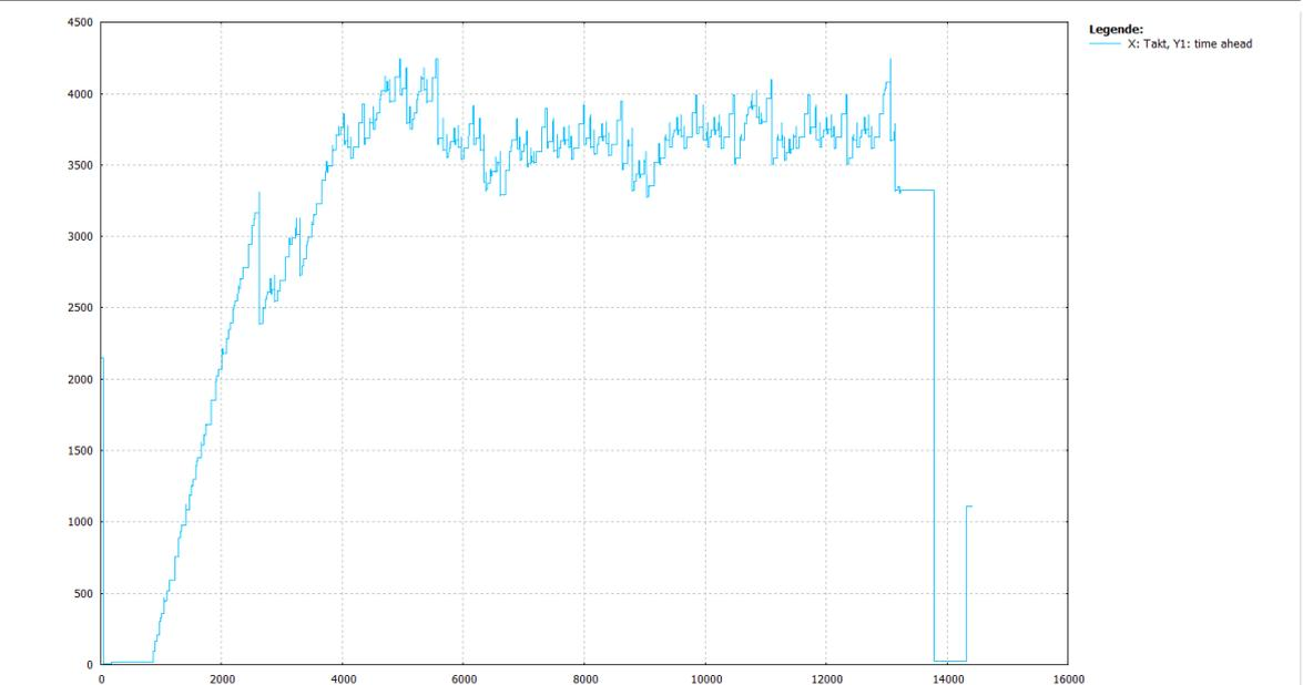
**Abb. 18: Vorlaufbegrenzung mit Berücksichtigung der Durchschnittsgeschwindigkeit (Default bzw. P-CHAN-00428 = 1), Satzversorgung ausreichend, System kann einschwingen. Deutlich verbesserte Vorlaufzeit zwischen 3s und 4s.**
