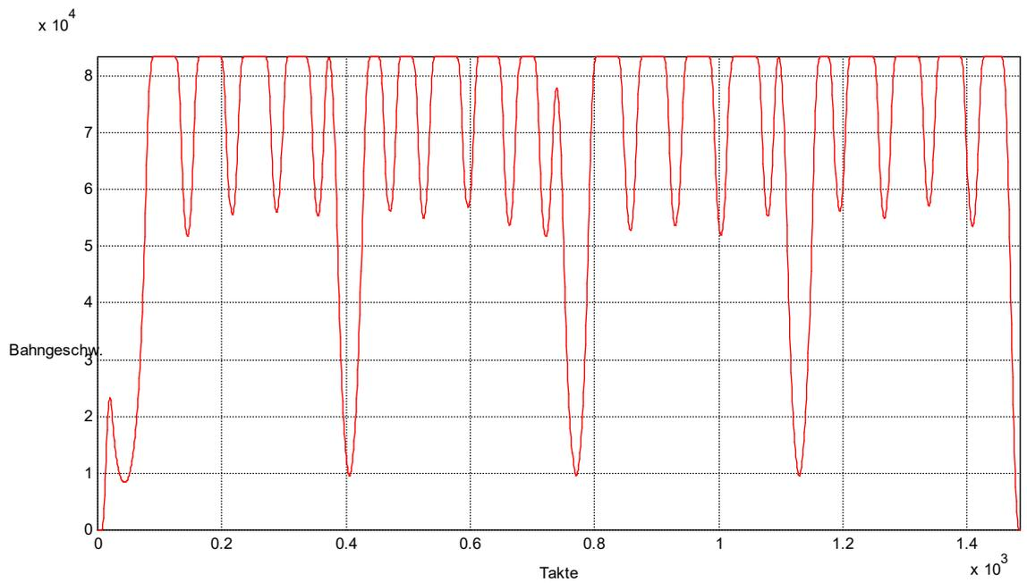
**Abb. 9: Vorlaufzeit: 0.2 Sekunden, Satzversorgung pulsiert stärker, Bahngeschwindigkeit schwankt**
