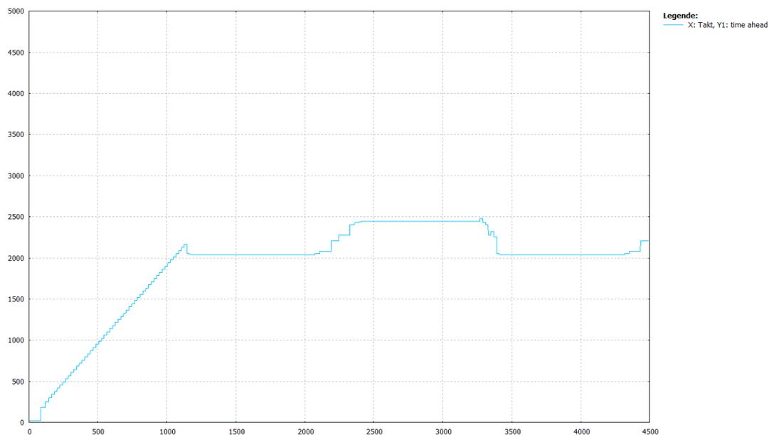
**Abb. 15: Vorlaufbegrenzung mit Berücksichtigung der Durchschnittsgeschwindigkeit (Default bzw. P-CHAN-00428 = 1, Satzlängen 40mm, ohne Vorschublimits)**
