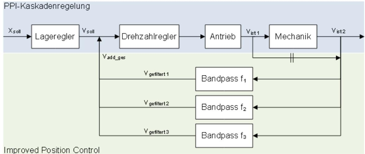
**Abb. 1: Erweiterung der Kaskadenregelung für den Modus „DIRECT“**
