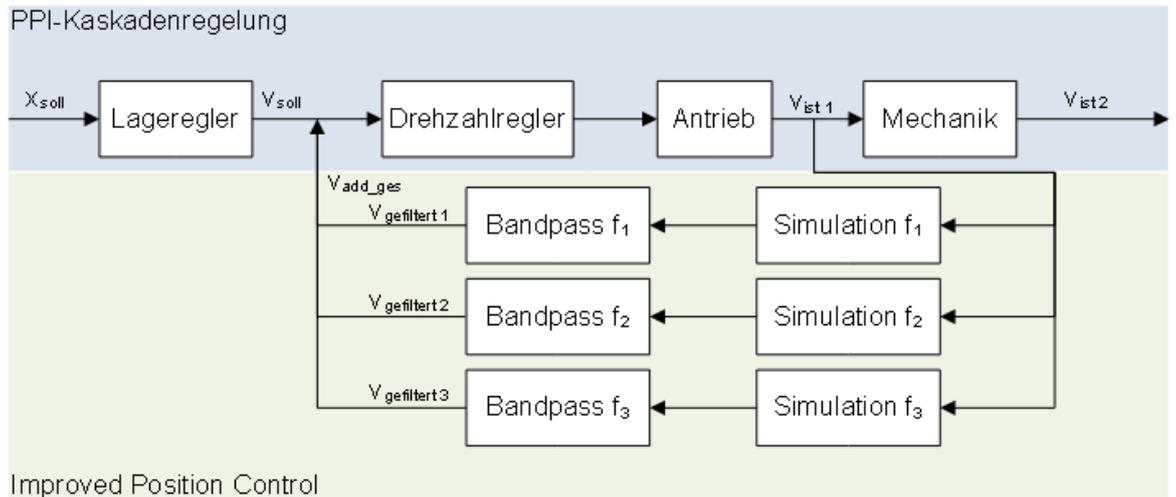
**Abb. 2: Erweiterung der Kaskadenregelung für den Modus "INDIRECT"**
